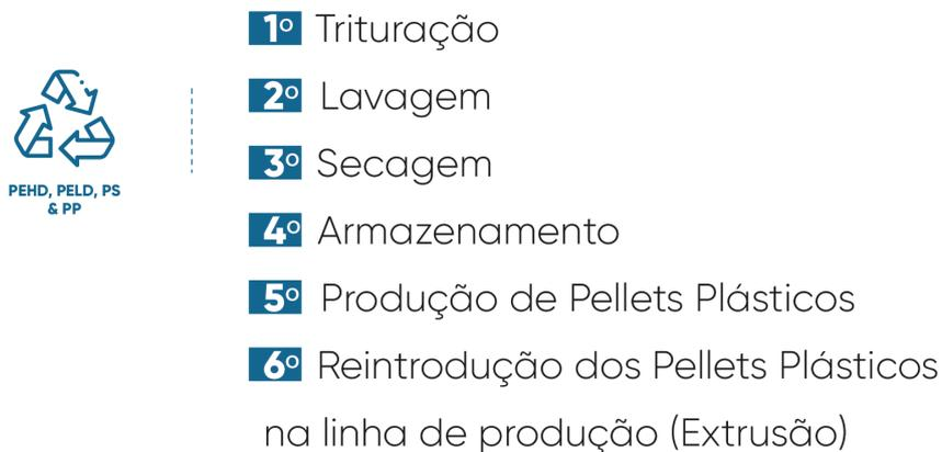
**Figura 2 - Processo de Reciclagem de PEHD, PELD, PS e PP**
