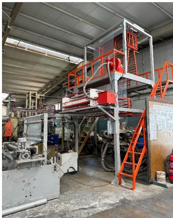
***Figura 8 - Máquinas de Extrusão***
